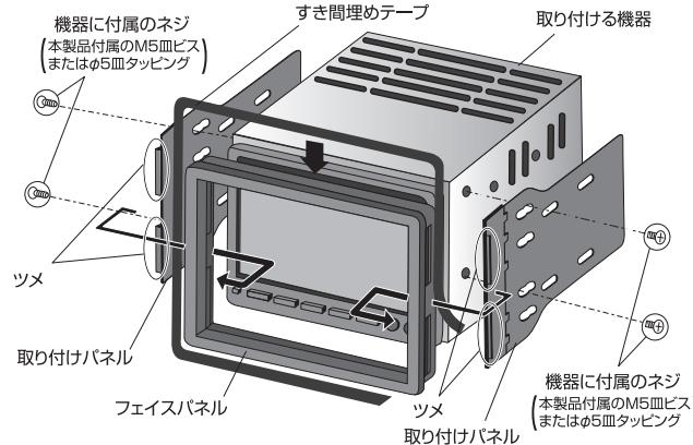
取り付けパネルの2箇所のツメをフェイスパネルの内側に合わせてください。
