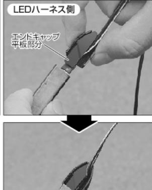
エンドキャップの平板部分をモール内側とLED基板の間に挿入してください。
