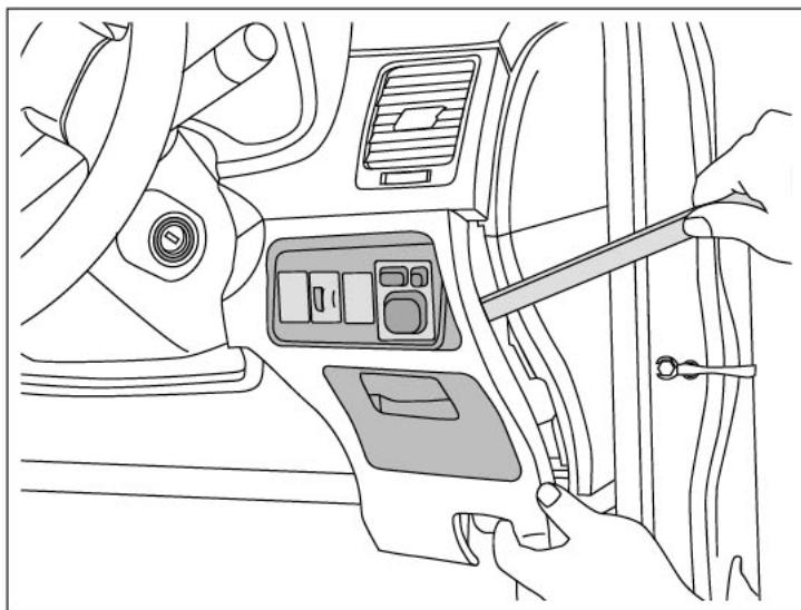
パネルはがし(別売)を使って丁寧に外してください。ネジ止め箇所がある場合はドライバーを使用して外してください。
