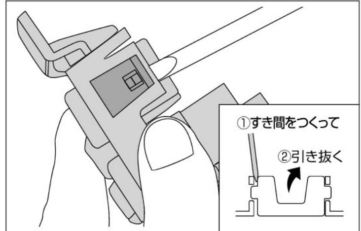
マイナスドライバーなどを使用してツメのロック部分にすき間を作り、後方に引き抜くように取り外してください。
